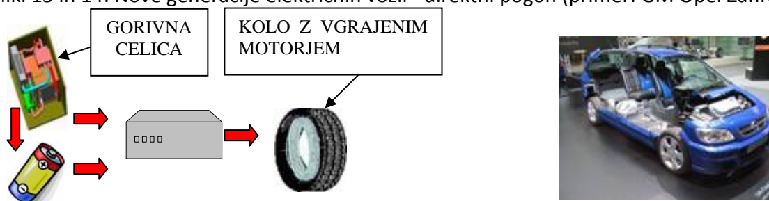
Sliki 13 in 14: Nove generacije električnih vozil - direktni pogon (primer: GM Opel Zafira)
